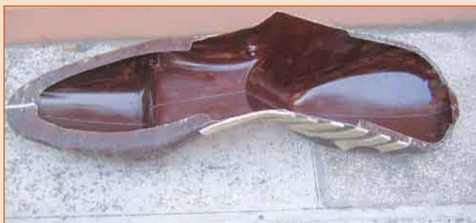
● Codone e coprisella sono stati realizzati in un pezzo monoscocca. Al fine di avere sempre a disposizione i ricambi in caso di caduta, è stato costruito uno stampo molto resistente.
