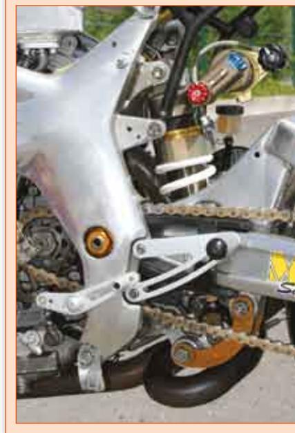
nata sopra l'attacco dell'ammortizzatore posteriore. Per praticità, il motorino di avviamento è stato mantenuto, ma viene alimentato in griglia di partenza da una batteria ausiliaria esterna, dato che tutto l'impianto di ricarica è stato eliminato.
