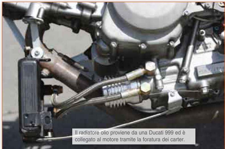
Il radiatore olio proviene da una Ducati 999 ed è collegato al motore tramite la foratura dei carter.
