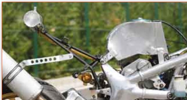
● Il telaio posteriore è realizzato completamente a mano per saldatura di tubi in lega di alluminio 6082. Il serbatoio di recupero dei vapori dell'olio fissato all'estremità è anch'esso costruito artigianalmente in lamiera di alluminio da 0,5 mm di spessore. Il serbatoio carburante, sempre in alluminio, è qui nella versione da 8 l, ma nel 2008 sarà rivisto per una capacità finale di 10 l.
