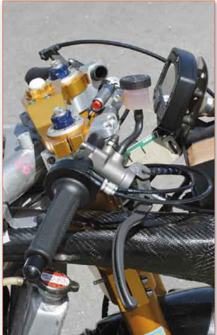
● Il dettaglio sulla manopola destra rivela i collarini artigianali che fissano i semimanubri ai foderi. I semimanubri, anch'essi artigianali, sono stati prodotti mediante fresatura di un tondino in ergal. Della Domino, invece, il comando gas a doppio filo, mentre la pompa freno è una Brembo radiale 19 x 18 mm.
