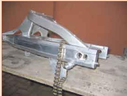
Le aole di passaggio del perno ruota posteriore sono state ingrandite per fresatura, al fine di montare un perno di maggior diametro prelevato da una Honda CBR 600. La modifica ha reso necessaria la costruzione artigianale in ergal dei nuovi pattini e della vite di registro.
