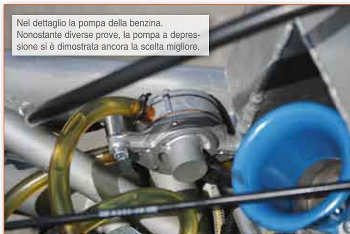
Nel dettaglio la pompa della benzina. Nonostante diverse prove, la pompa a depressione si è dimostrata ancora la scelta migliore.
