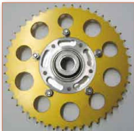
Anche le corone della trasmissione finale sono realizzate in casa in ergal.
