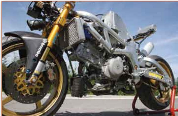
Una suggestiva vista della SV 700 spogliata. Il motore, in origine il bicilindrico Suzuki di 650 cm<sup>3</sup>, è stato aumentato di cubatura a quasi 700 cm<sup>3</sup> tramite l'impiego di pistoni Wiseco da 84,0 mm di diametro, ferma restando la corsa di 62,6 mm.
