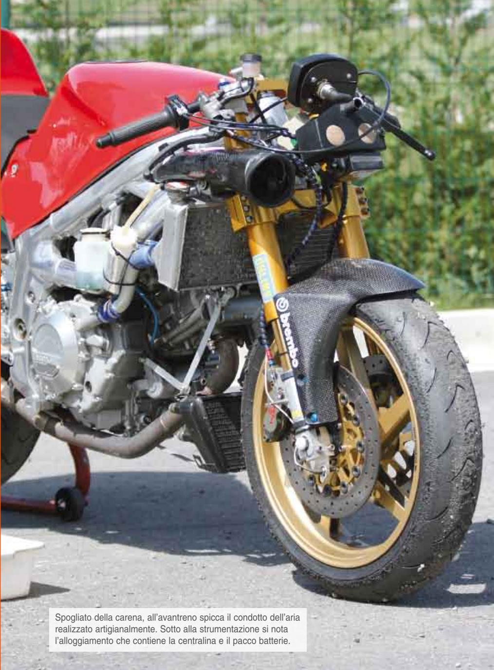
Spogliato della carena, all'avantreno spicca il condotto dell'aria realizzato artigianalmente. Sotto alla strumentazione si nota l'alloggiamento che contiene la centralina e il pacco batterie.
