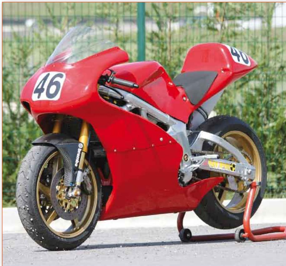
• Dopo tutte le lavorazioni e le modifiche, la massa della moto, in versione 2007, è di 137 kg in ordine di marcia. In bella vista, i dischi flottanti da 280 mm con pista in ghisa della Brembo, che originariamente equipaggiavano una 250 Gp. Le pinze sono Brembo a 4 pistoncini in ergal ricavate dal pieno.
