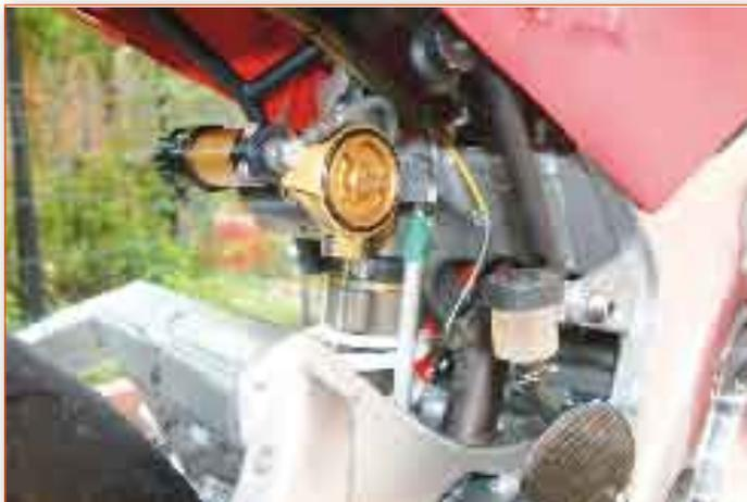
● Nel dettaglio, l'ammortizzatore posteriore con il relativo potenziometro per la misurazione dell'escursione che viene utilizzata come dato telemetrico.
