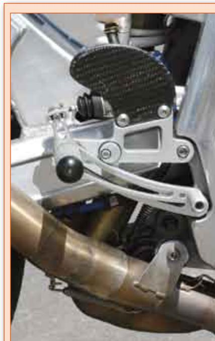
● Molto particolari anche i supporti per le pedane e le leve freno e cambio, tutte realizzate in alluminio 6082 per taglio ad acqua da una lamiera da 10 mm di spessore. In alto, la leva freno agisce sulla pompa tramite un'asola di raccordo che consente il fissaggio in tre diverse posizioni. La leva lavora su un eccentrico con O-ring inserito in una gola. In questo caso, la pedana funge anche da supporto per la pompa. In basso, anche la leva del cambio è regolabile su più posizioni.
