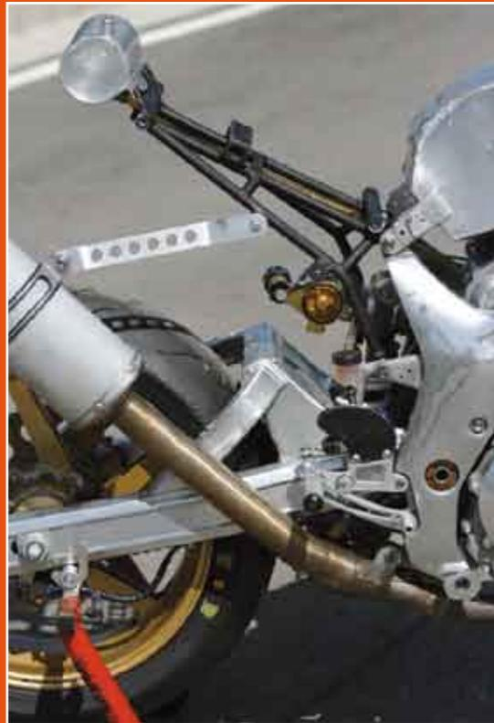
• Nel dettaglio, la capriata di rinforzo superiore prelevata da una Honda CBR 900 e adattata alle forme della piccola Suzuki.
