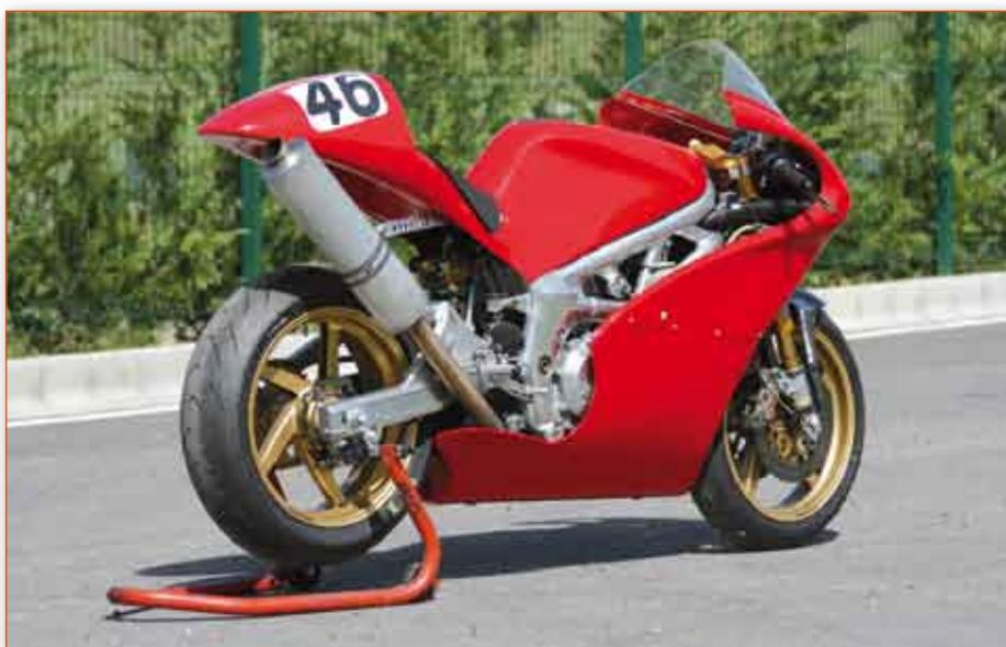
● Il telaio originale, da ben 14 kg, è stato lucidato a specchio per puro vezzo estetico del preparatore; la modifica, tuttavia, ottiene un gradevole risultato in accoppiata con il rosso brillante delle carene.
